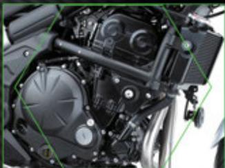
Mesin yang kompak disetling untuk menghasilkan torque maksimum pada putaran bawah dan menengah dengan efisiensi bahan bakar yang lebih baik.
