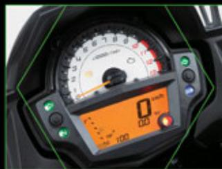
Instrument didesain bertumpuk dengan tachometer analog yang besar menggunakan LED sehingga mudah dilihat waktu malam.
